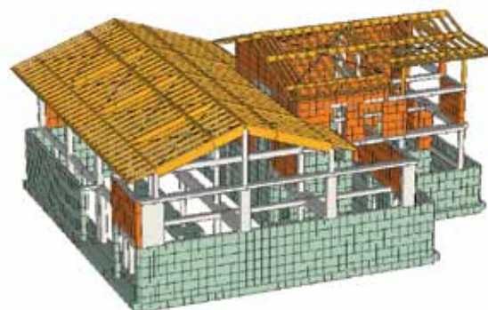
I carichi di solaio sono calcolati automaticamente ed applicati alle relative travi sia per solai unidirezionali che per solai a piastra (baricentrica, proporzionale a lunghezza o trapezoidale come in figura).
