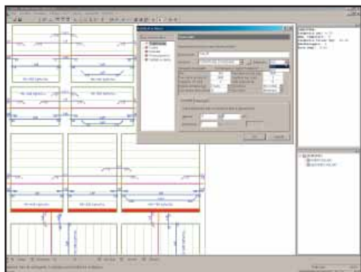
Parametri assegnati ad uno schema di solaio tralicciato; è possibile modificare qualsiasi parametro, come l'altezza del solaio, che può anche variare da campata a campata.
