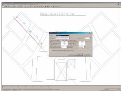
L'individuazione dello schema di solaio è completamente automatica, tutte le informazioni geometriche sono lette dal disegno.
