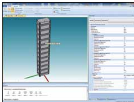
Rinforzo di un elemento in c.a. esistente tramite camicia di calastrelli e angolari in acciaio
